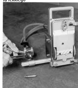
Łatwa wymiana dysz w urządzeniu IMP
