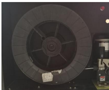
Zainstaluj drut na trzpieniu.
